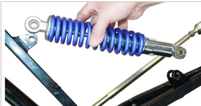
3.2.7. Устанавливаем амортизатор.
