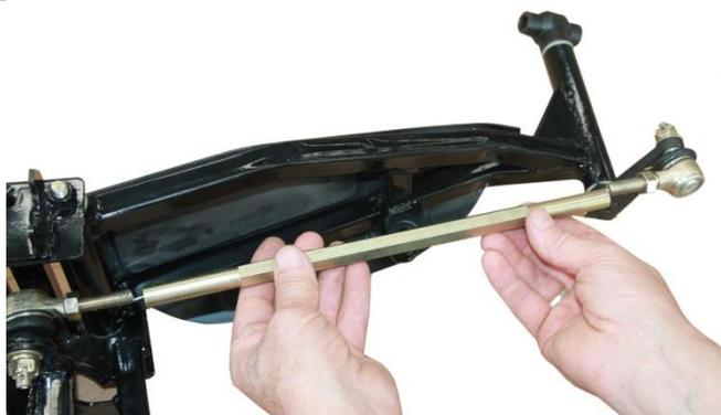
3.2.5. Устанавливаем рулевые тяги. Для этого совмещаем резьбу на рулевой тяге с резьбой на наконечниках рулевых тяг.
