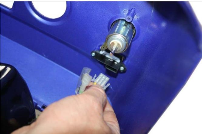
3.7.7. Подключаем колодки, показанные в пункте 3.7.5. к розетке для внешних приборов.
