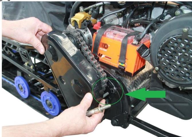
3.13.1. Устанавливаем кожух цепи. Обратите внимание на фиксатор кожуха (выделен зеленым цветом).
