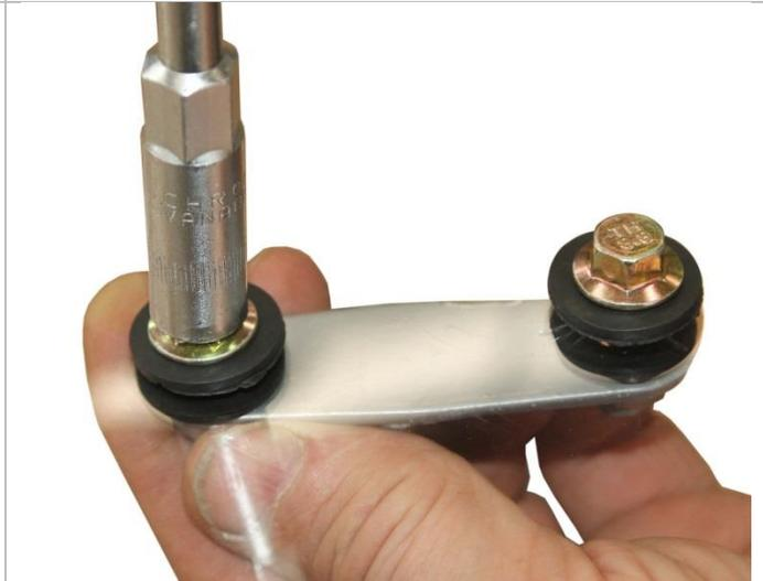
3.10.6. Соединяем кронштейн крепления ветрового стекла со стеклом.
