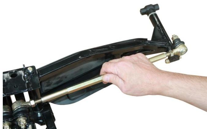
3.2.6. Закручиваем рулевую тягу по или против часовой (в зависимости от того, с левой или правой стороны снегохода она располагается). После окончательной сборки снегохода необходимо произвести их регулировку.
