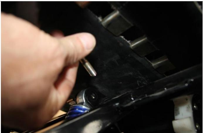
3.1.2. С помощью болта М10 и гайки М12 из комплекта поставки фиксируем его в рабочем положении.
