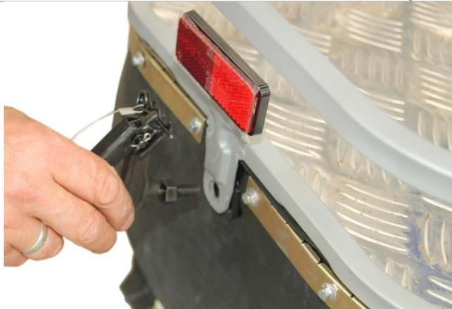
3.15.2. С помощью тягово-цепного устройства фиксируем багажник в рабочем положении.
