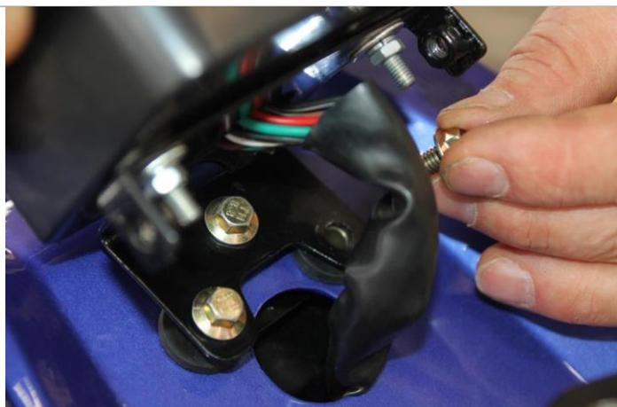
3.7.14. Для установки панели приборов понадобятся три болта М8 из комплекта поставки, показанные на рисунке.
