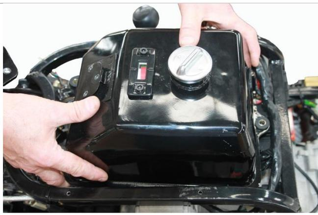
3.6.1. Перед установкой бензобака необходимо подсоединить шланг топливопровода к топливному крану, находящемуся на баке.
