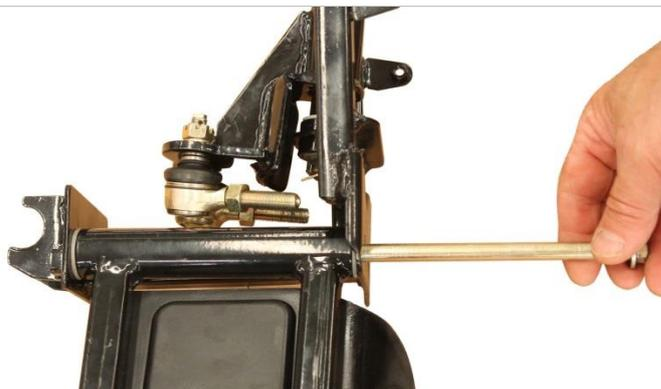
3.2.2. Устанавливаем левый и правый рычаги передней подвески и фиксируем их с помощью болтов из комплекта.
