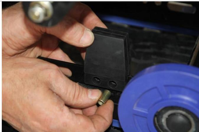
3.1.6. Устанавливаем демпферную резинку с левой и правой сторон снегохода так, как указано на рисунке. В крепежные отверстия устанавливаются втулки.
