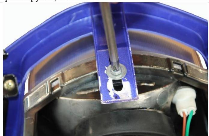
3.8.10. После того, как нужный угол установки фары найден, закручиваем винт крепления фары. После установки на снегоход необходимо отрегулировать распределение светового пучка фары.
