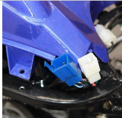
3.7.4. Указанные две колодки, выводим на правую сторону по ходу движения снегохода. Далее в пункте 3.7.10. к ним будут крепиться разъемы панели приборов.
