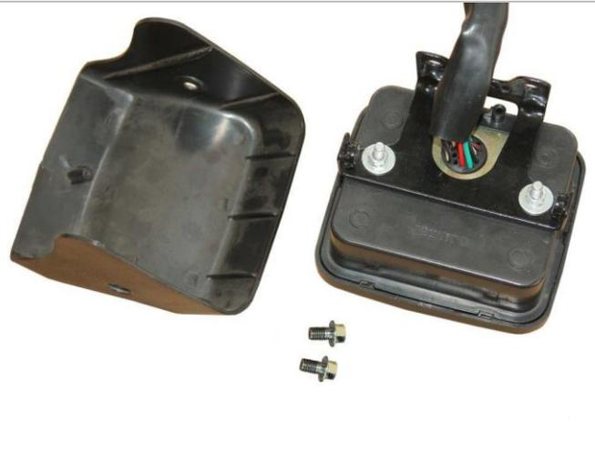
3.7.8. Откручиваем два болта, крепящих декоративную крышку панели приборов. Снимаем декоративную крышку панели приборов.
