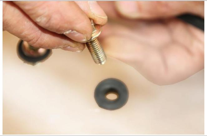
3.10.3. В крепежные отверстия с лицевой части стекла вставляем резиновые втулки. Затем в них вставляем болты.
