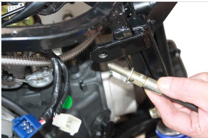
3.3.7. В верхней части снегохода с левой и правой его сторон фиксируем переднюю подвеску с помощью велосипедных винтов.
