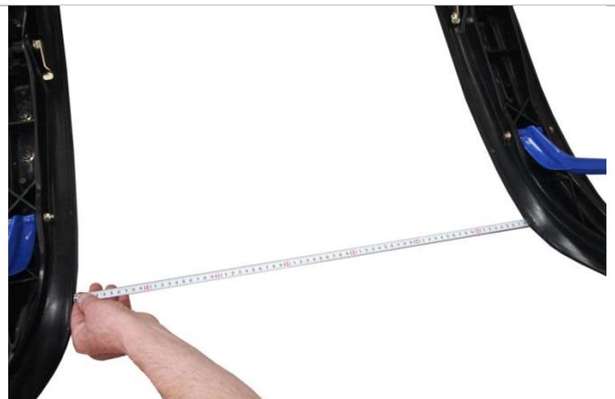
3.5.4. Рулеткой измеряем расстояние между лыжами спереди (фото 3.5.4.) и сзади (фото 3.5.5.). Разница измерений спереди должна быть не больше +5/+10 мм.
