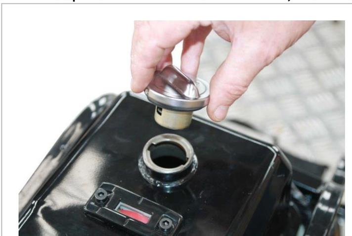
3.7.1. Снимаем пробку бака.
