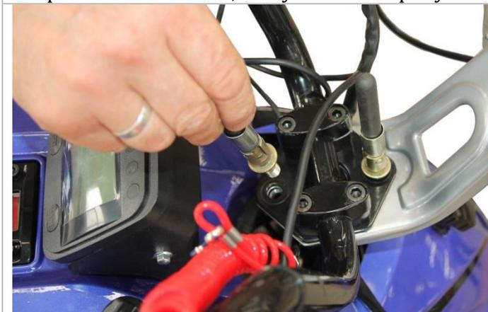
3.10.10. Фиксируем руль и кронштейн крепления стекла с помощью велосипедных винтов из комплекта поставки.
