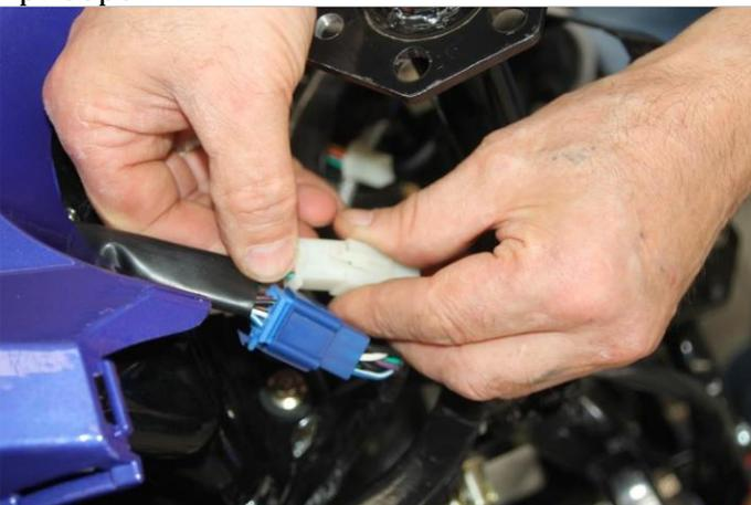
3.7.11. Подсоединяем колодки, находящиеся на жгуте проводов, к проводке снегохода – белую колодку к белому разъёму.
