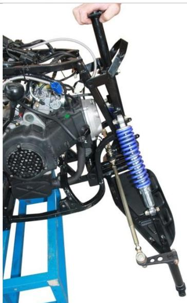
3.3.1. Стыкуем раму моторного блока с передней подвеской.
