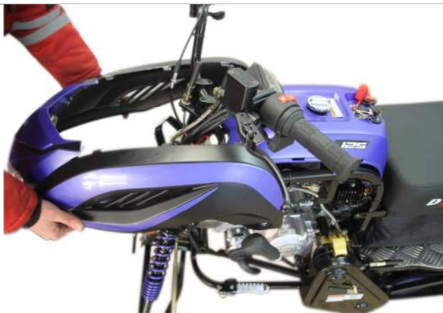
3.14.1. Устанавливаем ранее снятый передний пластик.
