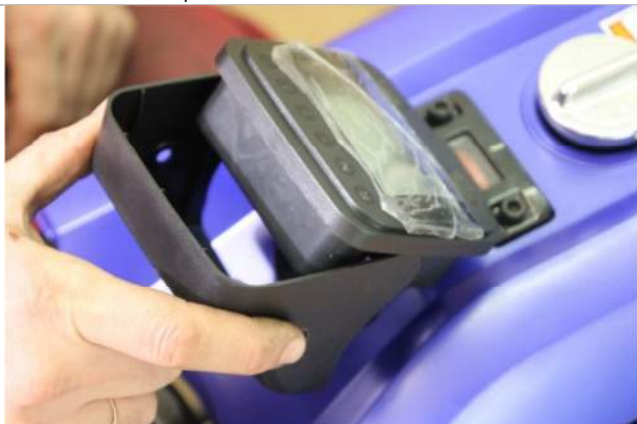
3.1.8. Одеваем декоративную крышку панели приборов.
