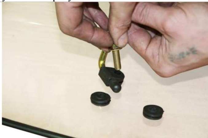
3.15.5. Прикручиваем кронштейн крепления лобового стекла к лобовому стеклу через ранее установленные прокладки так, как указано на рисунке.
