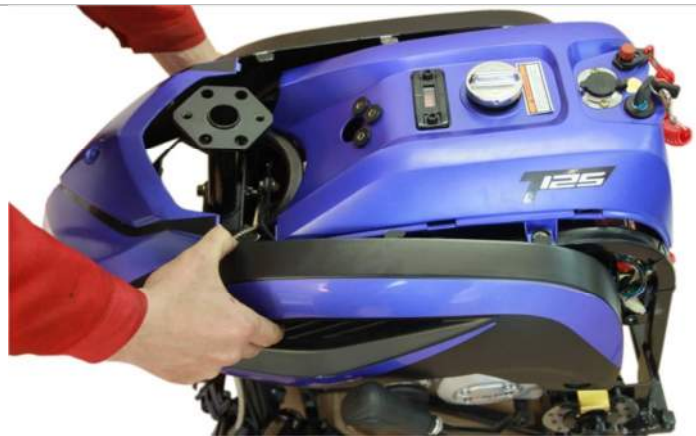
3.1.2. Снимаем пластик моторного блока.
