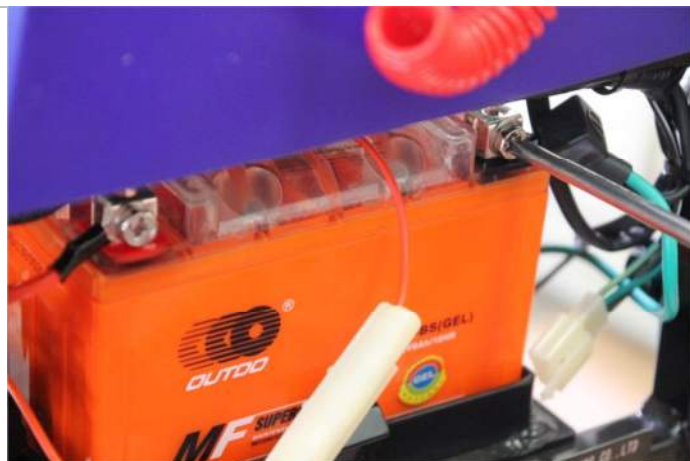
3.10.4. Устанавливаем клеммы согласно полярности, где красный это «+», черный соответственно «-».
