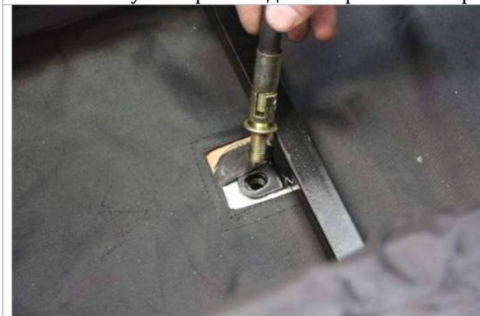
3.11.5. Фиксируем вело-болтами стойки сиденья на раме гусеничного блока. Полностью закручиваем болты только по окончании работ, описанных в пункте 3.14.8.
