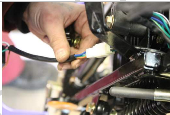
3.14.2. Подключаем разъем фары.
