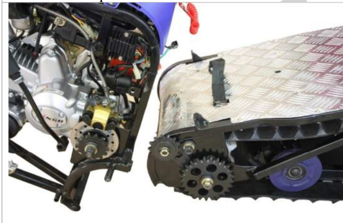
3.9.3. Устанавливаем блок двигателя и гусеничный блок друг напротив друга так, как указано на рисунке.
