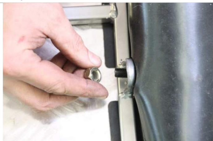
3.7.2. Фиксируем прицепное устройство с помощью гайки.
