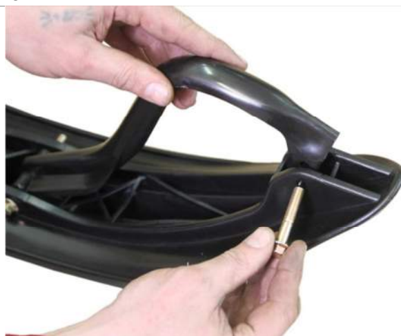
3.5.2. Фиксируем ее с помощью болтов из комплекта поставки.
