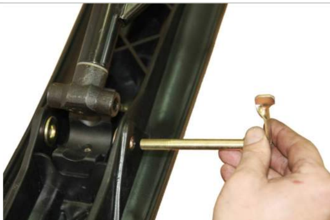
3.6.1. Соединяем вместе лыжу и рулевую стойку на рычаге.
