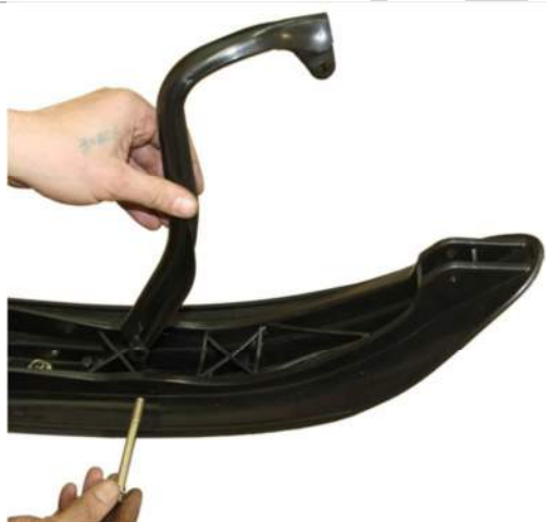
3.5.1. Устанавливаем ручку лыжи в посадочные площадки на лыже.
