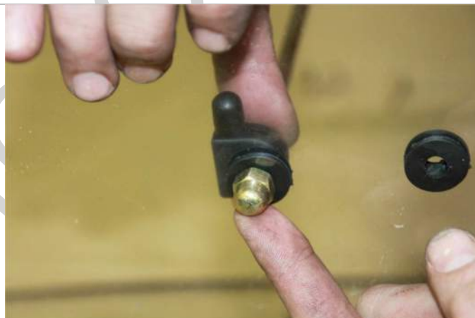
3.15.5. Прикручиваем кронштейн крепления лобового стекла к лобовому стеклу через ранее установленные прокладки так, как указано на рисунке.
