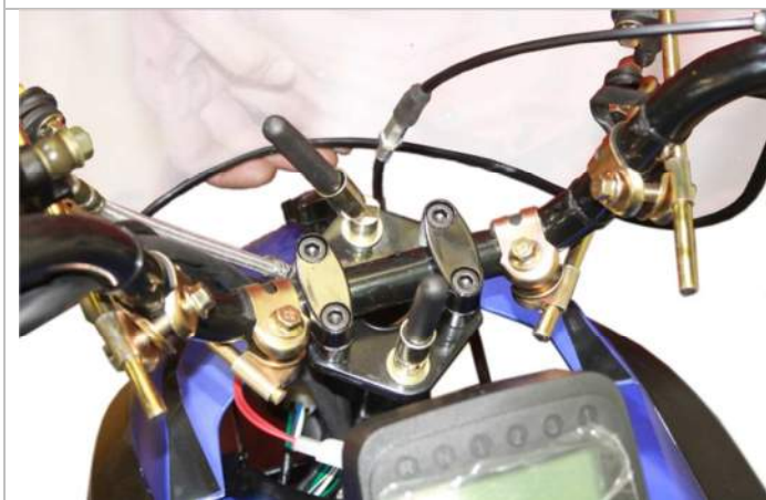
3.15.12. Устанавливаем лобовое стекло. Для этого пропускаем кронштейны, установленные на лобовом стекле, через малые хомуты.
