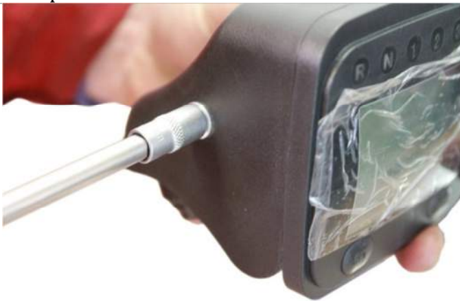
3.1.3. Откручиваем два винта крепления декоративной крышки панели приборов.
