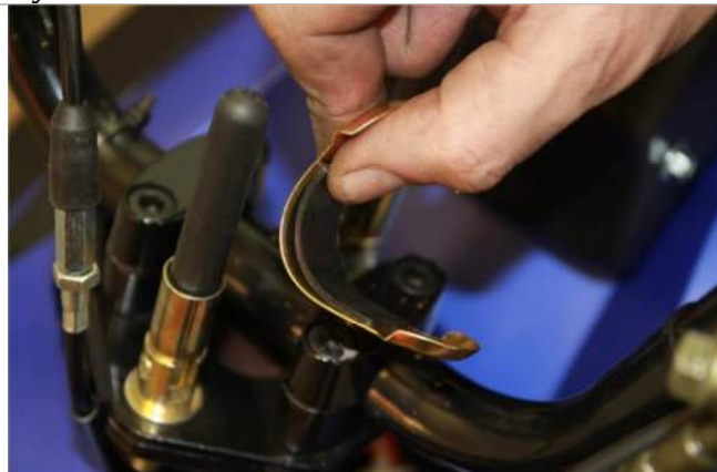
3.15.7. Устанавливаем хомут большой через резиновую прокладку на руль.
