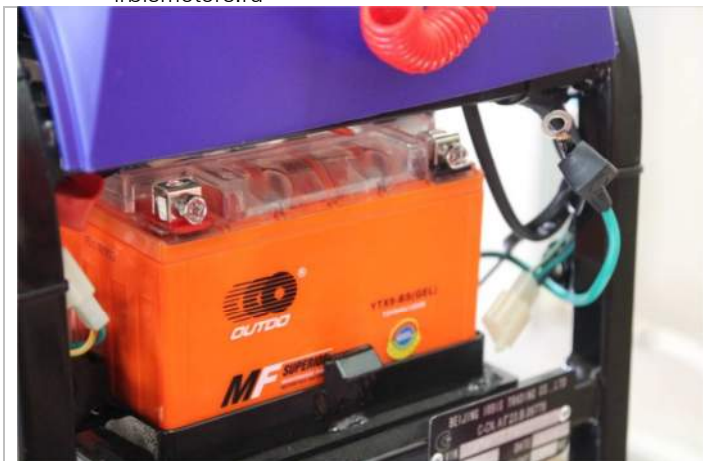
3.10.3. Снимаем с АКБ транспортировочную упаковку и устанавливаем АКБ в аккумуляторный отсек обратно.
