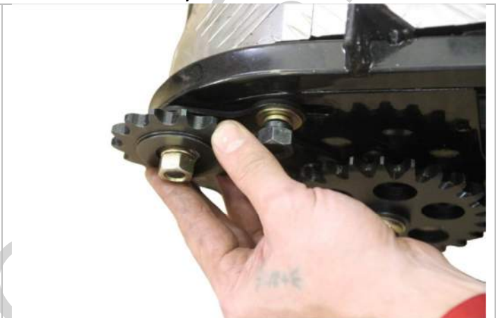
3.9.2. Переводим фиксатор в крайнее левое положение.
