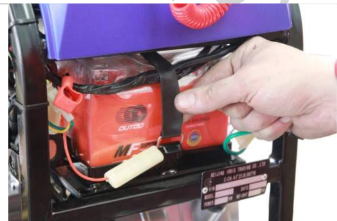
3.10.1. Снимаем резиновый фиксатор двигателя.
