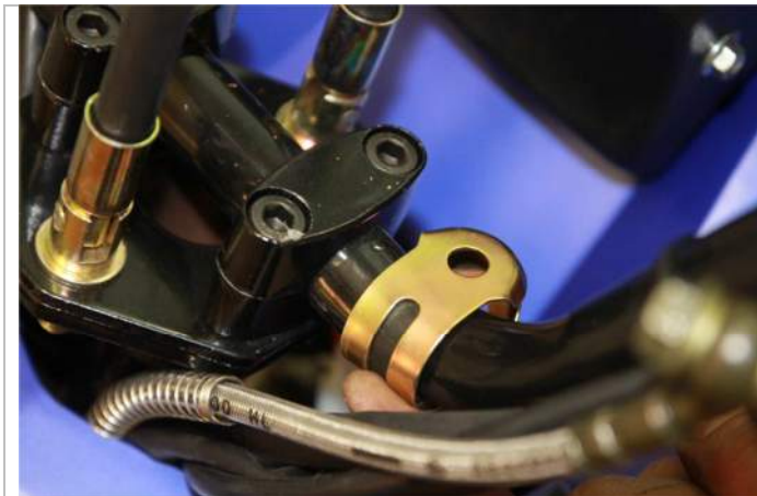
3.15.8. Устанавливаем хомут большой через резиновую прокладку на руль.
