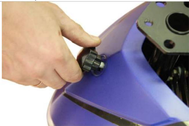
3.1.1. Откручиваем болт крепления пластика моторного блока.
