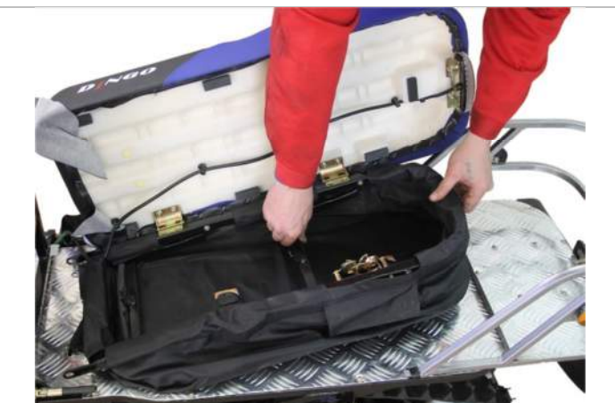
3.11.2. Откидываем сиденье. Переводим стойки сиденья в вертикальное положение.
