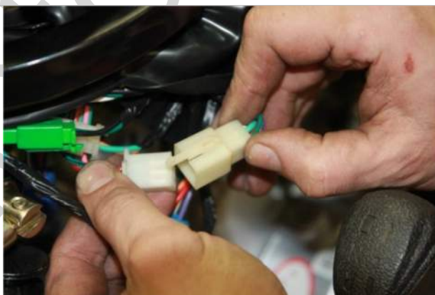
3.1.11. Подсоединяем колодки, находящиеся на жгуте проводов, к проводке снегохода – белую колодку к белому разъёму.
