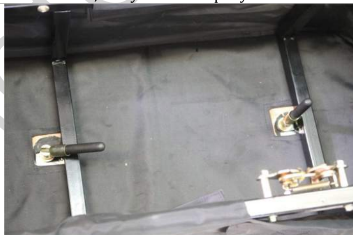
3.11.5. Фиксируем вело-болтами стойки сиденья на раме гусеничного блока. Полностью закручиваем болты только по окончании работ, описанных в пункте 3.14.8.
