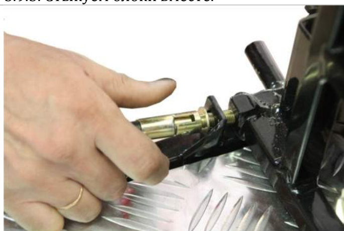
3.9.6. Фиксируем два блока вместе с помощью вело-болтов.
