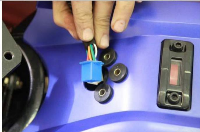
3.1.5. Пропускаем жгут проводов, идущий от приборной панели через технологическое отверстие в пластике. Устанавливаем панель приборов.
