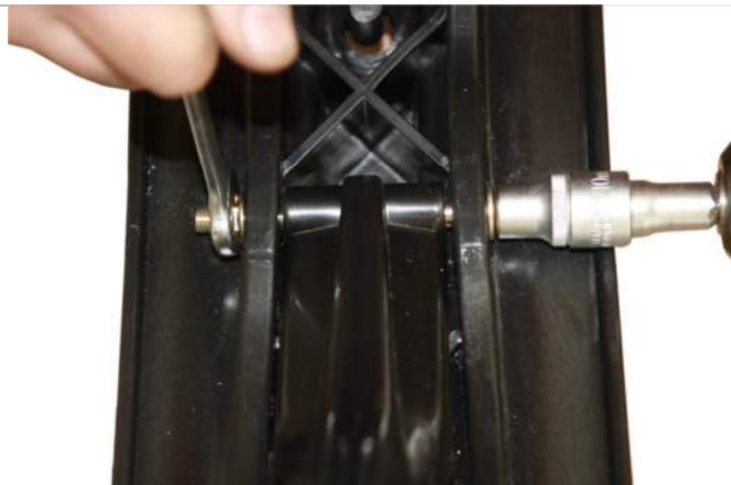
3.5.3. Навинчиваем гайку. С помощью инструмента затягиваем резьбовые соединения.
