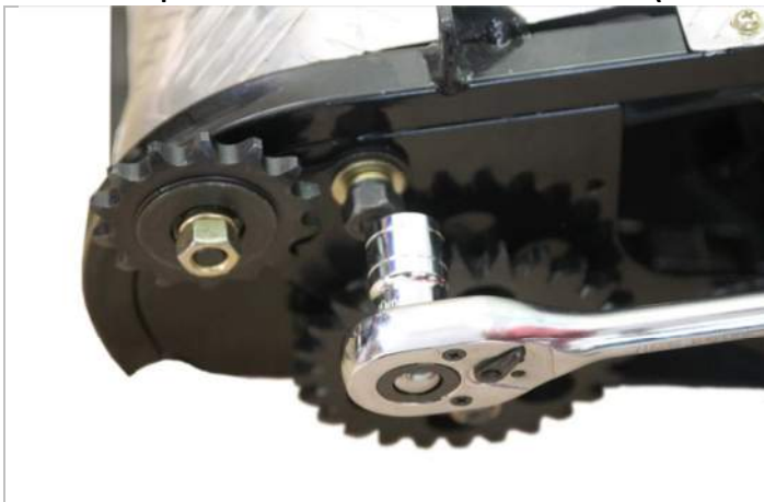
3.9.1. Откручиваем гайку фиксатора натяжителя резьбы.
