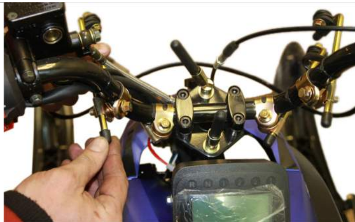
3.15.16. Устанавливаем резиновые заглушки.
