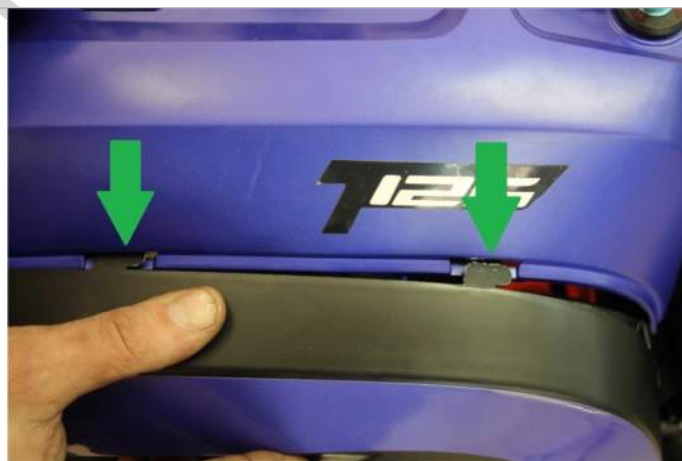
3.14.3. Устанавливаем пластик так, чтобы крепежные выступы пластика садились в технологические отверстия так, как указано на рисунке стрелками.
