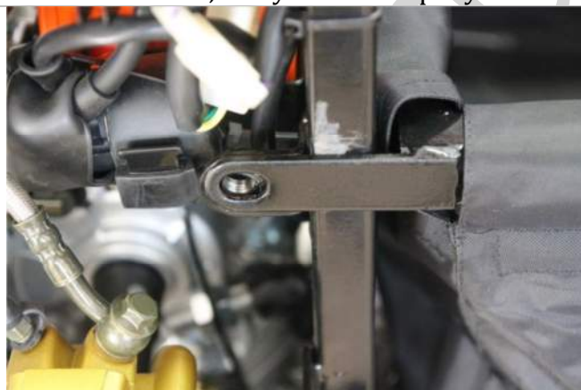
3.11.4. Стыкуем каркас сиденья с рамой моторного блока так, как указано на рисунках.
