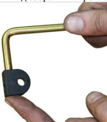
3.15.4. Соединяем вместе кронштейн крепления лобового стекла, его хомут и заглушки так, как указано на рисунках.
