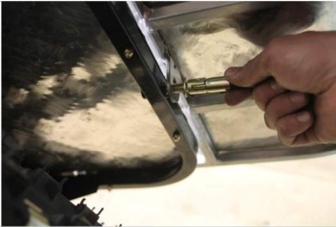
3.8.3. С помощью вело-болта фиксируем багажник к раме снегохода.
