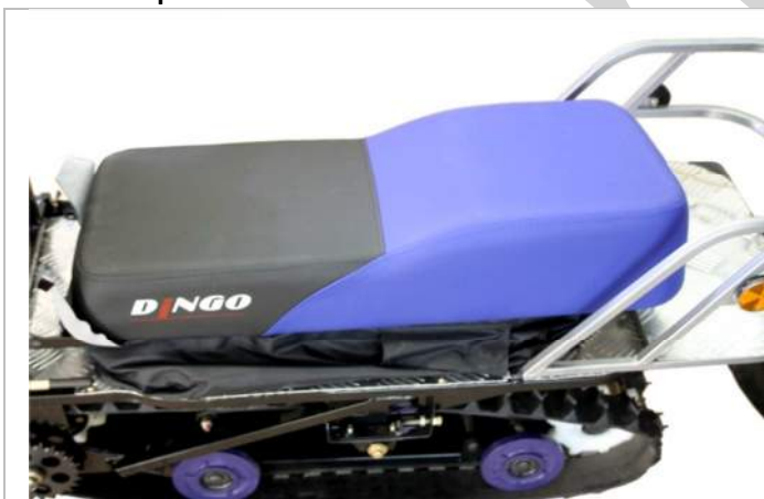
3.11.1. Устанавливаем сиденье на гусеничный блок.
