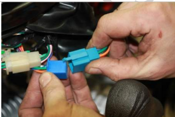
3.1.12. Подсоединяем колодки, находящиеся на жгуте проводов, к проводке снегохода – голубую колодку к голубому разъёму.
