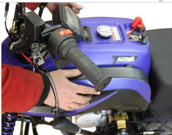
3.14.3. Устанавливаем пластик так, чтобы крепежные выступы пластика садились в технологические отверстия так, как указано на рисунке стрелками.
