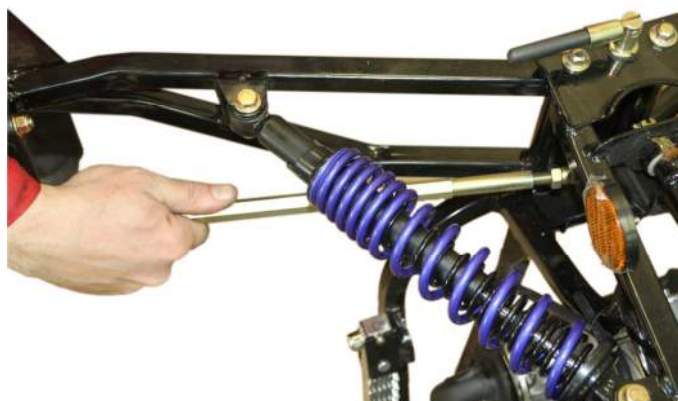
3.4.8. Закручиваем рулевую тягу по или против часовой (в зависимости от того, с левой или правой стороны снегохода она располагается). После окончательной сборки снегохода необходимо произвести их регулировку.
