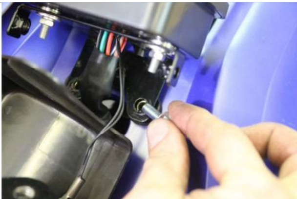
3.1.7. С помощью болтов из комплекта поставки прикручиваем панель приборов
