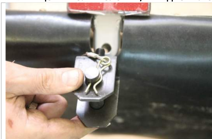
3.7.1. Устанавливаем прицепное устройство в технологическое отверстие.
