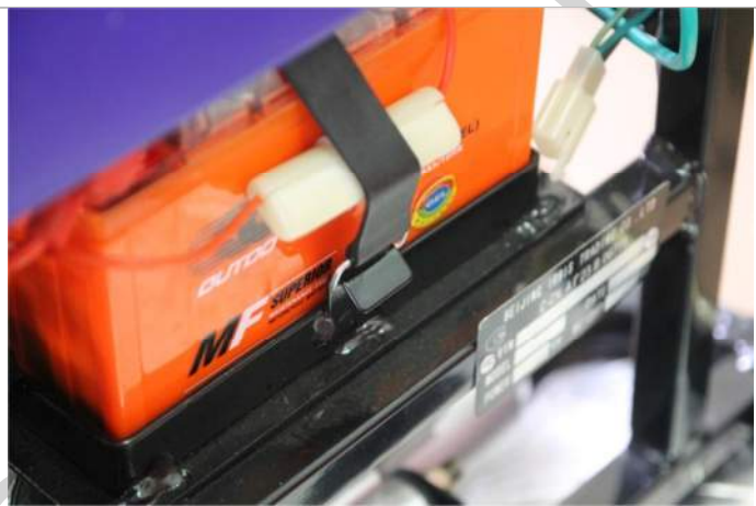
3.10.4. Устанавливаем клеммы согласно полярности, где красный это «+», черный соответственно «-».
